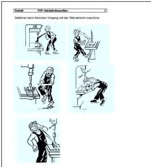
Technik UUV- Ständerbohrmaschine
